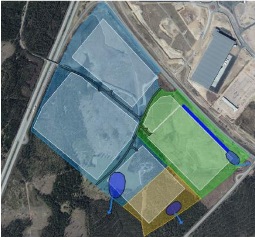
Kartan ovan visar ungefärligt ytbehov av föreslagna dagvattenanläggningar och föreslagen placering samt utloppsriktning för respektive avrinningsområde. Mörkblå ovaler = dagvattendammar; mörkblå streck = svackdike; ljusblå pilar = riktning för utlopp. Karta från den till detaljplanen tillhörande dagvatten och skyfallsutredningen (Sweco 2025)
