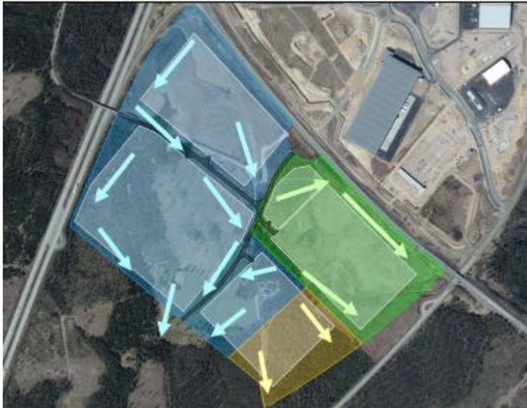
Förslag till flödesriktning för avledning av vatten vid skyfall. Grön = avrinningsområde A; gul = avrinningsområde B; Blå = avrinningsområde C. Karta från den till detaljplanen tillhörande dagvatten och skyfallsutredningen (Sweco 2025)
